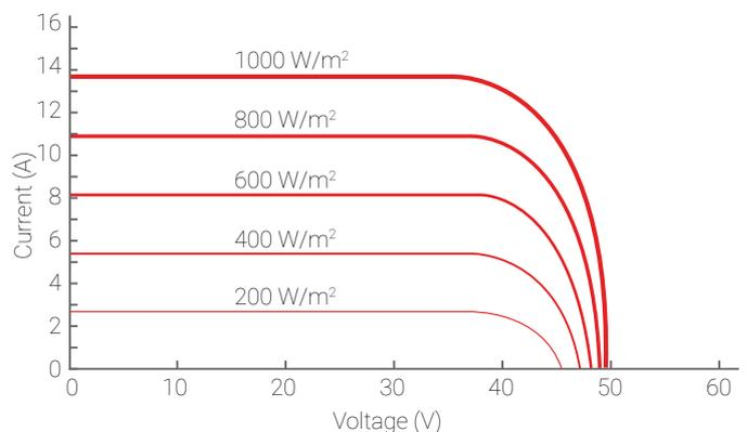
\*Стандартные условия испытания (1000Вт/м<sup>2</sup>; 25°C температура элементов, AM 1.5)
