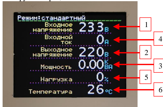
Рис.№3. Индикатор в режиме текстового отображения электрических параметров.
