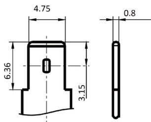
**Рисунок А2.** Внешний вид и габаритные размеры выводов подключения внутренних АБ в ИБП ST1101SL
