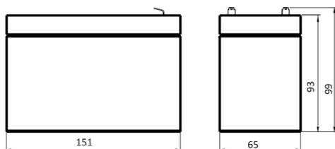
**Рисунок А1.** Внешний вид и габаритные размеры внутренних АБ в ИБП ST1101SL
