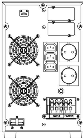
**Рисунок 11.** ИБП Штиль ST1103TL. Выводы «Вход L-N-PE»
