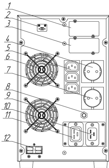
**Рисунок 3б.** Компоненты задней панели ИБП Штиль ST1102SL, ST1102L, ST1103SL и ST1103L
