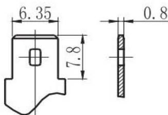
**Рисунок А4.** Внешний вид и габаритные размеры выводов подключения внутренних АБ в ИБП ST1102SL и ST1103SL
