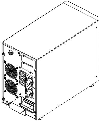
**Рисунок 13.** Крепление защитного кожуха на выводы подключения входной сети и нагрузки ИБП Штиль ST1103TL
