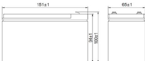
**Рисунок А3.** Внешний вид и габаритные размеры внутренних АБ в ИБП ST1102SL и ST1103SL
