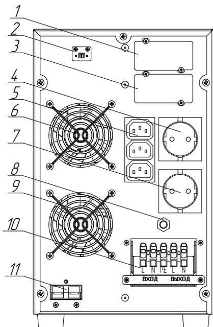
**Рисунок 3в.** Компоненты задней панели ИБП Штиль ST1103TL
